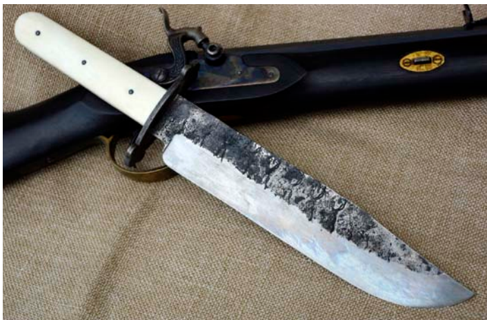
Kotěrovův tesák osazený paroží a kroužkem se záštitou podle vlastní fantazie. Čepel byla vykovaná z pásového čepu od tanku T-34
